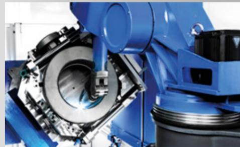
Durch einen vollautomatischen Schweißroboter mit integriertem Mess-System wird die Dichtfläche mit Stellite aufgepanzert. Die CNC Programme werden von hauseigenen Programmierern erstellt. Die genaue Synchronisierung der acht Achsen des Schweißsystems sorgt für eine hohe Produktqualität.
