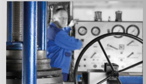
Jede ZETRIX® Prozessarmatur wird gemäß DIN EN 12266 auf Dichtheit geprüft. Prüfdrücke und Prüfzeiten sind im computergestützten Prüfstand hinterlegt. Sonderprüfungen sind auf Kundenwunsch möglich.
