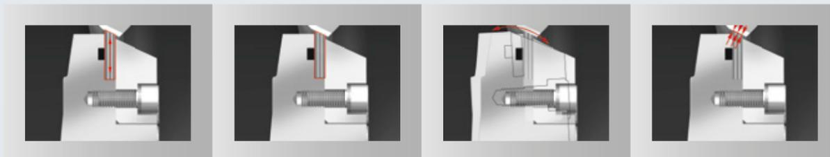
Selbstzentrierender Dichtring ermöglicht Wärmekompensation und gewährleistet Dichtheit auch bei hohen Temperaturschwankungen.
