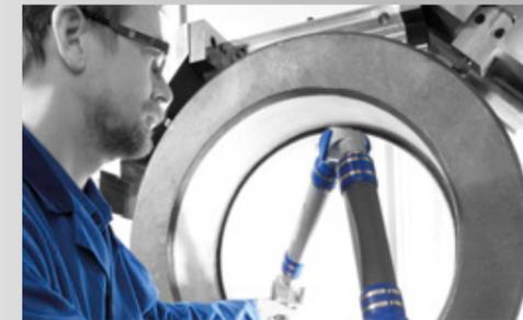
Mit dem dreidimensionalen Mess-System können die Armaturen gegen 3D Daten gemessen und gescannt werden. Diese werden auf einem PC ausgewertet und gespeichert. Die Messung erfolgt direkt in der Maschine und unterstützt eine prozesssichere Fertigung.
