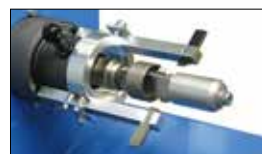
Gleichzeitiges Innen- und Außenschälen möglich (USM 100)
