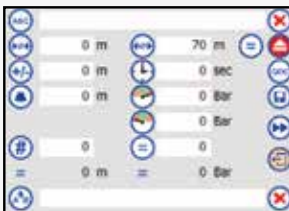
Eingabe von Pressmaß, Korrekturwerten, Haltezeit, Öffnungsdurchmesser, Vorwahlzähler und Pressbacken (automatisch).
