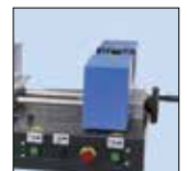
Axial verstellbare Spanneinheit verhindert das Knicken kleiner Schlauchnennweiten.
