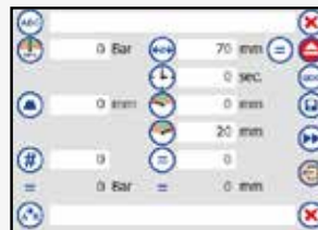
Eingabe von Druck, Haltezeit, Öffnungsdurchmesser, Vorwahlzähler und Pressbacken.
