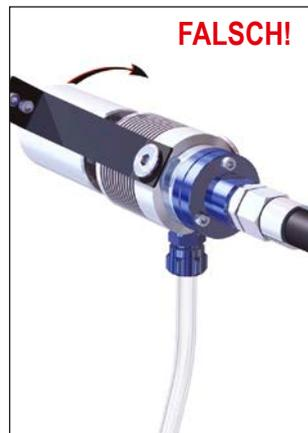
**FALSCH!** Gehäuse der Drehdurchführung ist starr mit der Spindel verbunden. Ohne 100% perfekte Ausrichtung kommen Seitenlasten auf die Lager und führen zu frühem Ausfall.
