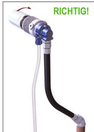
**RICHTIG!** Flexibler Schlauch zwischen fester Verrohrung und Drehdurchführung. Leckageleitung zeigt gerade abwärts.
