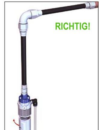
**RICHTIG!** Wenn der Versorgungsschlauch unter Druck steht, verhindert ein Winkelstück Seitenlasten auf die Lager.
