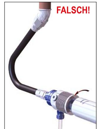
**FALSCH!** Biegung im Versorgungsschlauch zu eng. Unter Druck könnte der Versorgungsschlauch hohe Seitenlasten auf die Lager verursachen.
